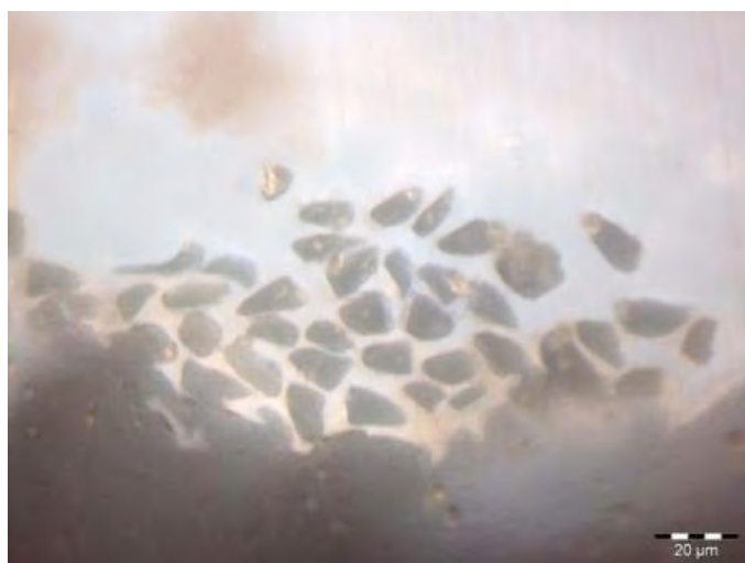
Fig 6 : Coupe du tissu 2 : section des fibres de la soie Bombyx Mori . © Musée du quai Branly/Christophe Moulherat.
