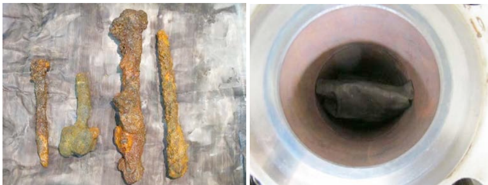
Figure 8: Clous de provenance sous-marine traités par les fluides subcritiques. ©A-CORROS
