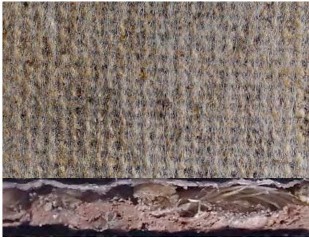
Fig. 14. Photos comparatives des renforts collés (non tissé polyester et papier japon)
