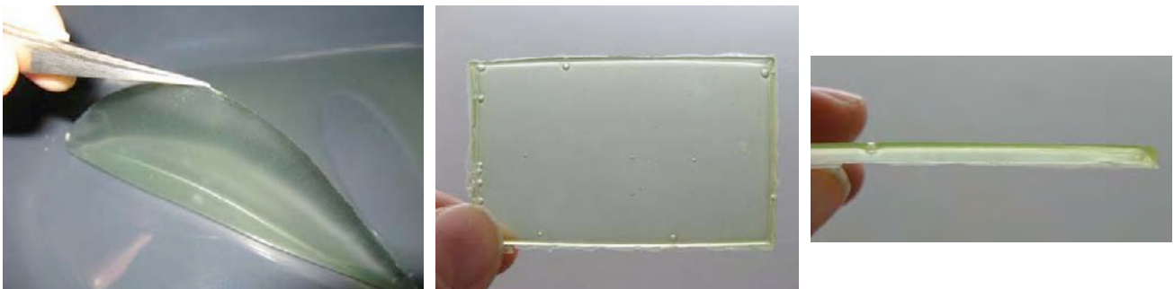
figure 13 : Fabrication des feuilles de résine acrylique
