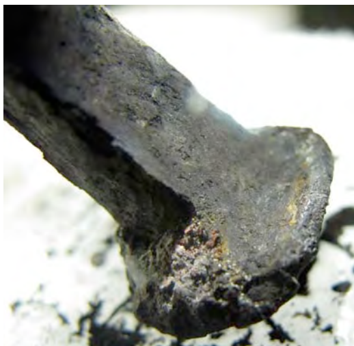
Figure 13: gangue en cours de dégagement. Observation de la présence de la gangue avec des cristaux de silice caractéristique, et présence de la surface d'origine noire mate.
